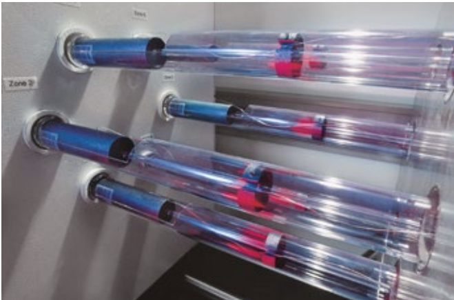
↑ Thermische Prüfung zur Längenausdehnung
