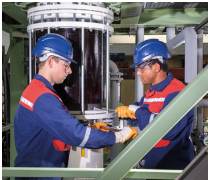
↑ 开车前法兰连接的最终检验
